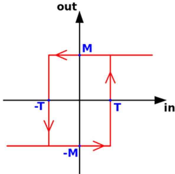
$$(+/-)V_{Trigger} = (+/-)V_{cc} \times (R1/R2)$$
