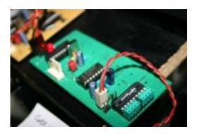
SpeakJet-IIC-Module Breadboard v1.3
